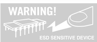
**注意：**本产品为静电敏感元件，请注意防护！ESD 损害的范围可以从细微的性能下降扩大到设备故障。精密集成电路可能更容易受到损害，因此可能导致元件参数不能满足公布的规格。
